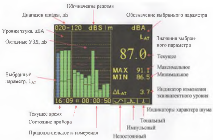
Рис. Вид дисплея при измерении уровня шума
