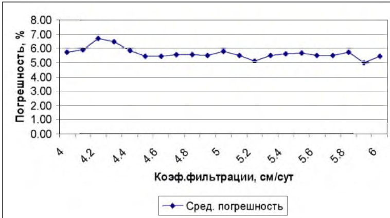
Рис. 2. График средней относительной погрешности вычисления запасов влаги в почве в зависимости от величины коэффициента фильтрации, C = 1,1 (суглинок тяжелый)
