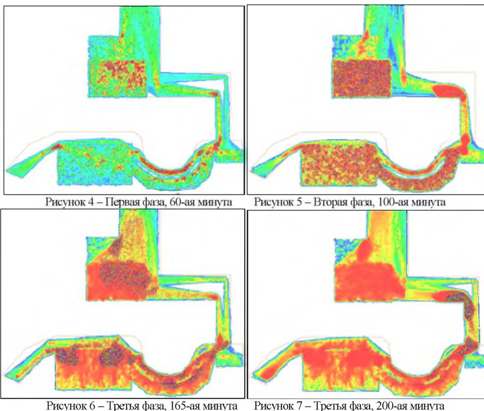
Компьютерная модель позволяет лучше понять процессы поведения пешеходных потоков на стадионе, визуализировать эти потоки, рассчитать пропускную способность и среднее время пребывания пешеходов в различных зонах стадиона, создать динамические карты плотности зрительских потоков. Полученные результаты могут быть использованы в целях обеспечения безопасности во время проведения крупных спортивных мероприятий, а также учтены при очередной реконструкции стадиона.
