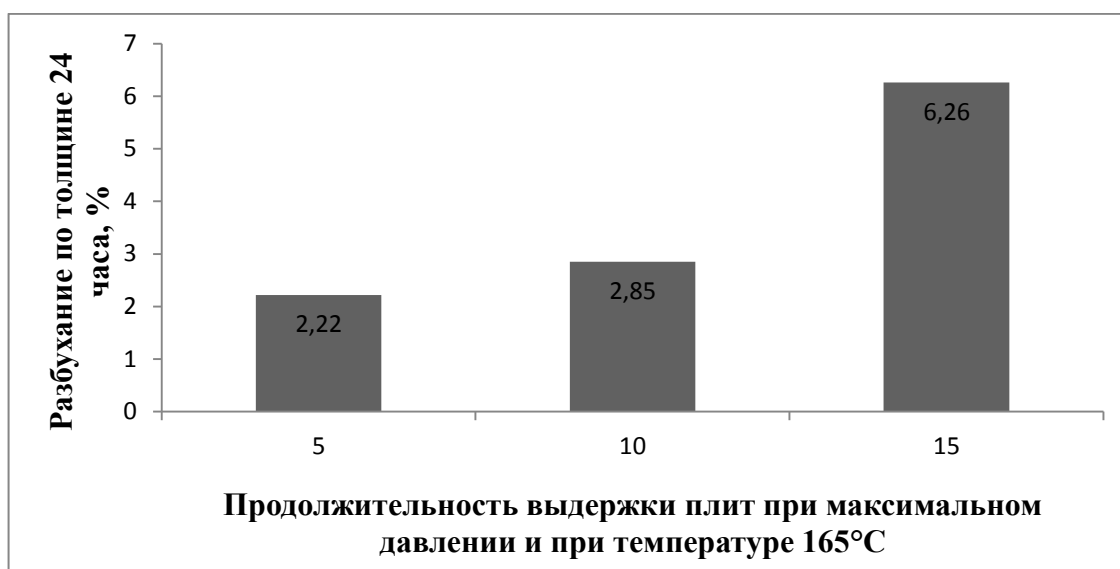
Рисунок 12 – Влияние продолжительности прессования плитных материалов при давлении 10 МПа и температуре 165°C на разбухание по толщине за 24 ч
