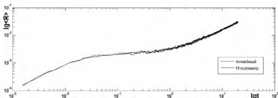
Рисунок 4 – Кривые среднего смещение центра масс макромолекул линейного полимера и h-полимера от времени при  $N = 7$ ,  $V=2265$ ,  $\chi = 0,02$ ,  $\psi = 23$
